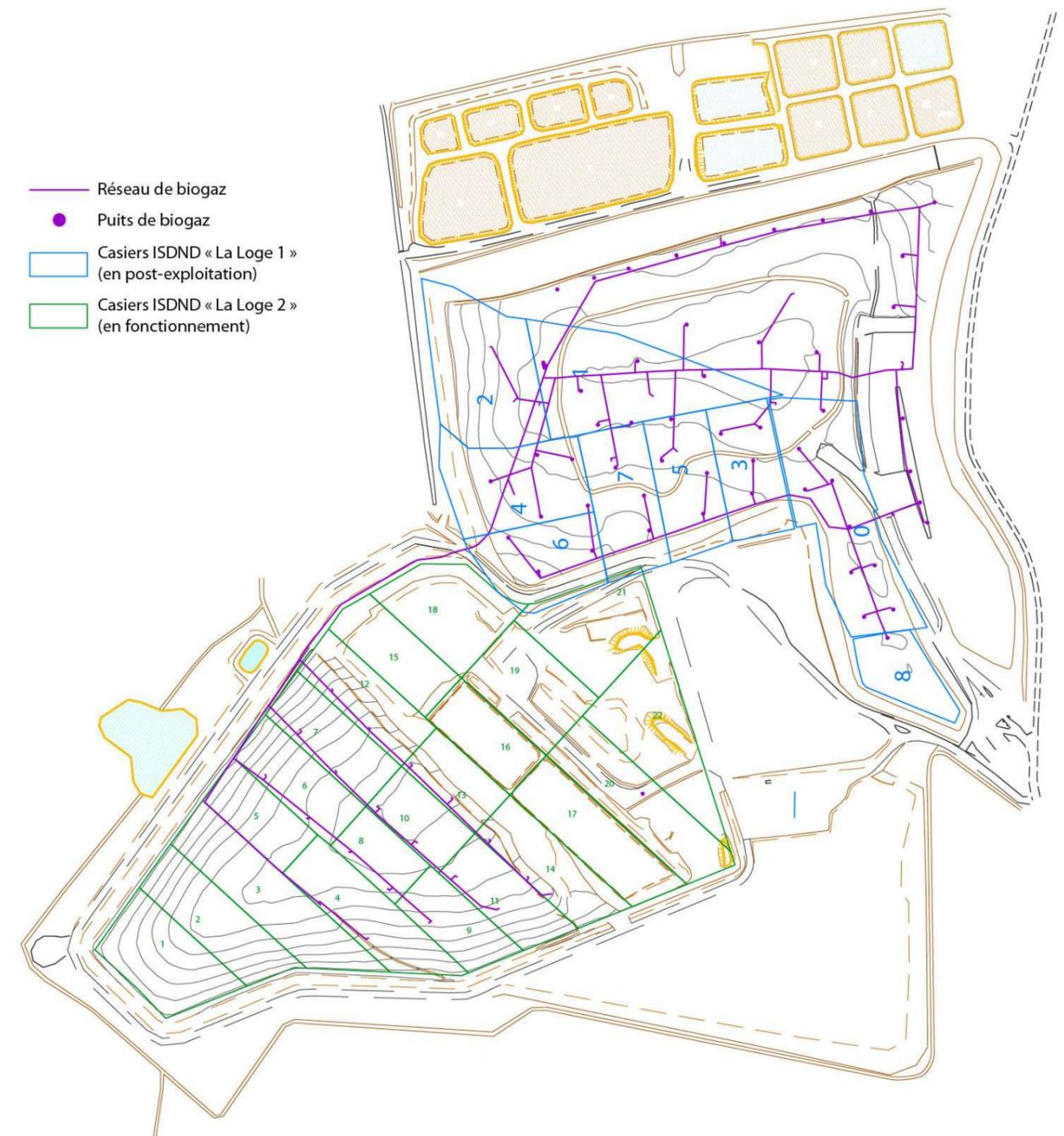
Réseau de biogaz sur les ISDND des « Loges 1 et 2 » (extrait du plan de masse)
